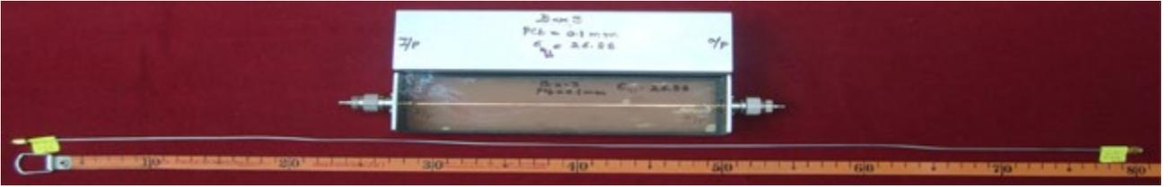
चित्र 7: 205 मिमी लंबी 7 आरएफ पारेषण लाइन पर पीसीबी = 0.1 मिमी मोटी + 10 मिमी जल 772 मिमी लंबी आरएफ केबल पर के बराबर है।
