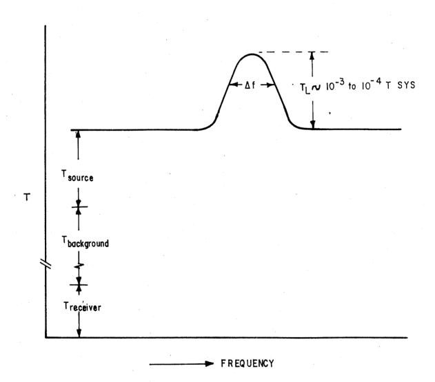
FIG C.1 A TYPICAL SPECTRAL LINE
