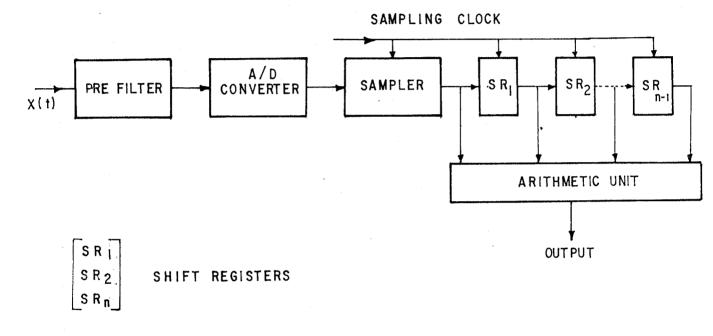
FIG.A .3 HARDWARE IMPLEMENTATION OF AN n STAGE MULTIBIT DIGITAL TRANSVERSAL FILTER
