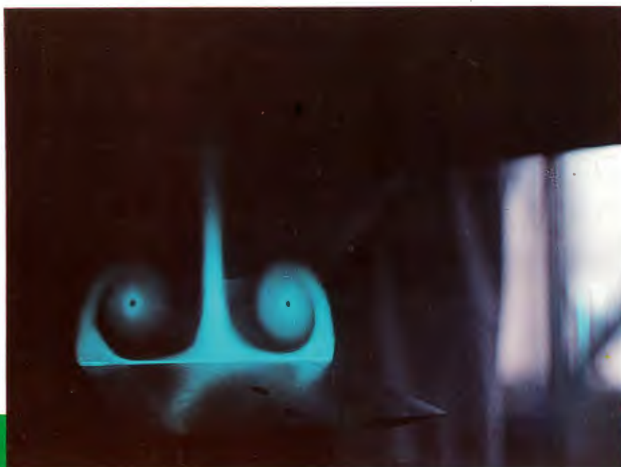
利用風洞蒸汽屏技術進行渦場顯示 Vortex visualization using vapour screen technique
