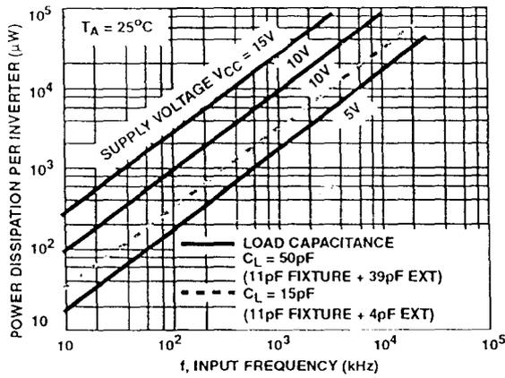
FIGURE 10. TYPICAL POWER DISSIPATION vs FREQUENCY CHARACTERISTICS
