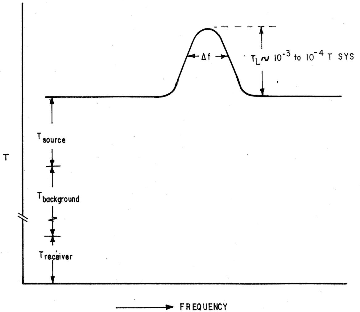
FIG C.1 A TYPICAL SPECTRAL LINE
