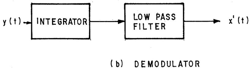
FIG. A .1 HARDWARE IMPLEMENTATION OF A DELTA MODULATION SYSTEM
