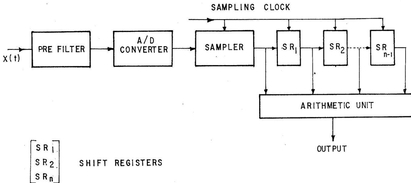
FIG.A .3 HARDWARE IMPLEMENTATION OF AN  $n$  STAGE MULTIBIT DIGITAL TRANSVERSAL FILTER
